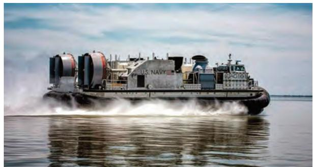
Il secondo esemplare di «*Ship-to-Shore Connector*, SSC», designato LCAC 101, ripreso nel corso delle prove d'accettazione al cospetto del *Board of Inspection and Survey* dell'*US Navy* (Fonte: Textron).
