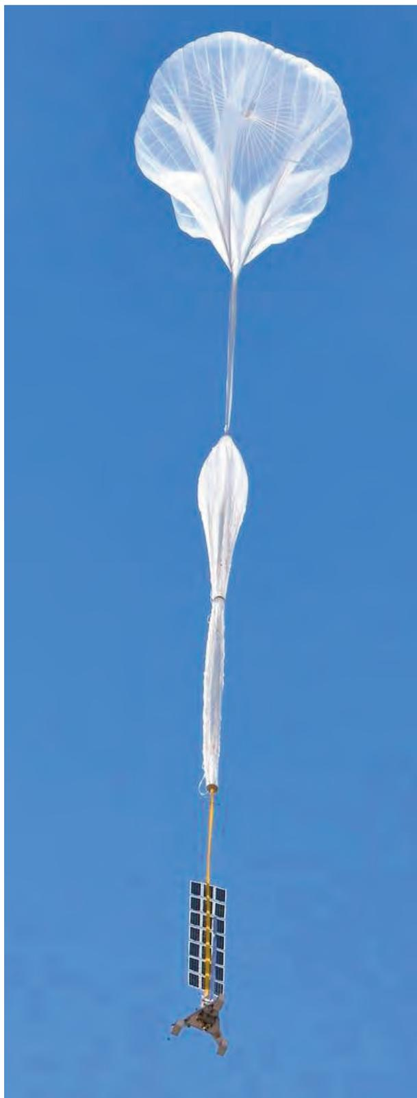
Esempio di pallone stratosferico. Il World View Stratollite costituito da pallone principale e secondario, pannello solare e payload (Fonte: [nasa.gov/image-feature/world-view-stratollite-test](https://nasa.gov/image-feature/world-view-stratollite-test)).
